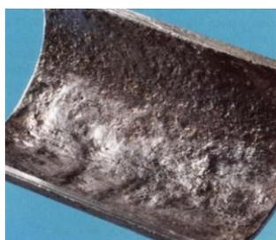
Bild 2 : Muldenbildung und Lochfrass unter der Rostschicht
