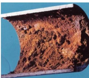
Bild 1 : Rostbildung bei verzinkten Stahlleitungen
